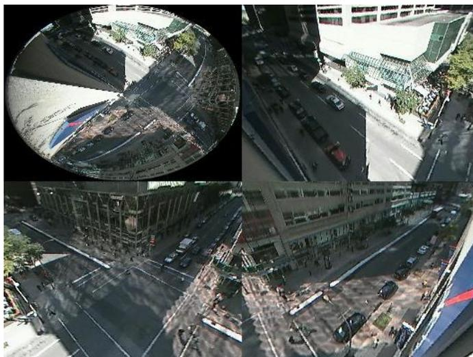
**OBS:** Lentes panomórficas não funcionam como as lentes "fisheye", ou seja, uma câmera fisheye deve ser integrada de acordo com seu fabricante. A vantagem da lente panomórfica é que ela pode ser utilizada em qualquer câmera.
