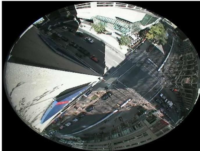
Com essa integração, o sistema faz o chamado "dewarping", ou seja, retira a distorção e é possível ver a imagem normalmente. Esse tipo de lente funciona muito bem com câmeras mega-pixels, pois com apenas uma câmera é possível focalizar todos os ângulos de uma sala e dividir a imagem como se fosse diversas câmeras. Veja o exemplo abaixo:
